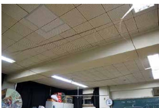
実験室の天井には1周が10mの40回巻きのコイルが設置してある。これに外部スピーカー端子からの音楽を流す。この下で、直径20cmで40回巻きのコイルにクリスタルイヤホンをつないだものを設置すると相互誘導により音楽を聞くことができる。
