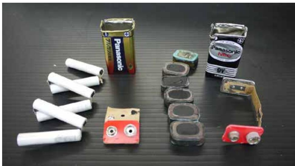
9V乾電池を開けてみると、写真のような電池が現れる。アルカリタイプは、単4電池よりさらに細い筒状の電池が6本直列つなぎになって入っている。マンガンタイプは写真右側のように積層型の6個の電池が直列つなぎになって入っている。9Vの電位差を作る電極を利用しているのではない。
