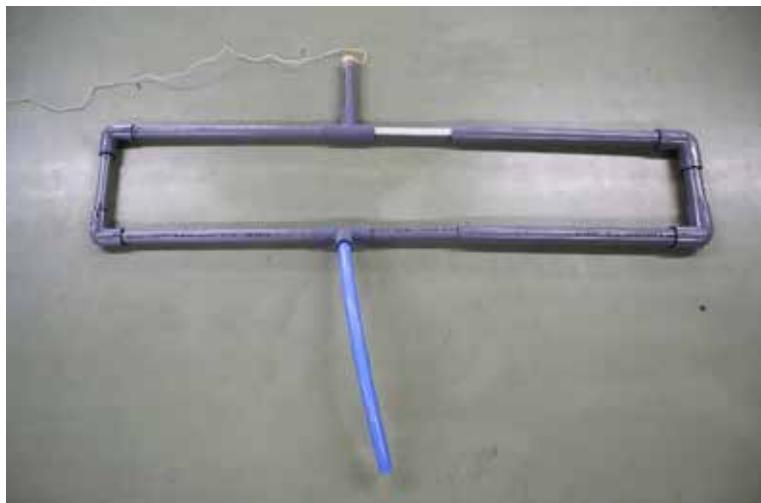
クインケ管は、10班分をそろえると大変高価になるので、水道管で自作する。水道管の規格はVP20とVP13を組み合わせて作成した。スピーカーは大きいので、クリスタルイヤホンを使用する。音を聞くための水道ホースをつないでおくと、小さな音を聞くのに便利である。
