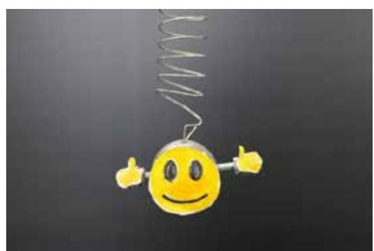
ウィルバーフォース振り子は、上下振動と、おもりの回転運動を交互に行う振り子である。適当なバネと釣り用のおもりをつなぎ、上下運動させて10回分の時間を計る。バネをつり合いの状態にして、おもりを回転させ、10回分の時間を計る。これが一致するようにおもりの両サイドにうで（ネジを切った棒）をつけ、ワッシャーやナットをつけて調整する。この2つの時間がぴったり合うとウィルバーフォース振り子が完成する。重力による位置エネルギーと、上下方向の運動エネルギーと、回転の運動エネルギーの合計は常に保存されている。
