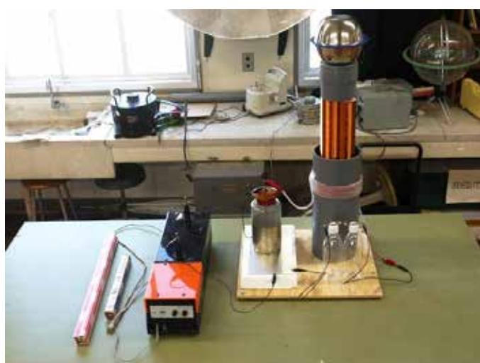
テスラコイルから発生する交流電流は、数 100kHz の高周波電流のため強い表皮効果が生じて電流の大部分は導体の表面を流れ、人体の内部には電流がほとんど流れないことになる。写真は 1 次コイルが 10 回巻き、2 次コイルが 800 回巻きで生徒がつくったものである。指先からの放電や、蛍光灯の点灯ができた。
