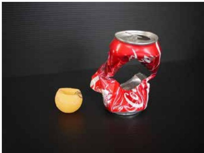
長さ 2m、内径 40mm の塩化ビニル管の一部に排気のための穴を空け、真空ポンプとつなぐ。ピンポン球を内部に入れ、塩ビ管の両側の穴をニチバン社のセロテープ（No.405）を貼って密閉する。内部を真空にした後、片方のセロハンテープを鉛筆などで穴を空け破裂させると、流入する空気が内部のピンポン球を押し、理論上音速を超えた速度で、ピンpong球はもう一方のセロハンテープを突き破って飛び出す。この塩ビ管の出口に、コカコーラの空き缶（アメリカ製が缶が薄い）を固定すると、ピンpong球が貫通する。
