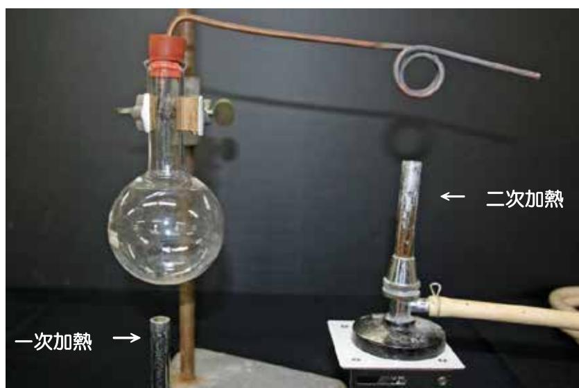
生徒は湯気を水蒸気であると思っている。湯気は水蒸気が凝結して粒子が大きいため白く見えている。水蒸気は水分子が離れているため白くは見えない。水を温めた水蒸気を再度暖めると200°C以上の水蒸気を作ることができる。もちろん透明である。マッチを近づけると、水蒸気で火をつけることができる。
