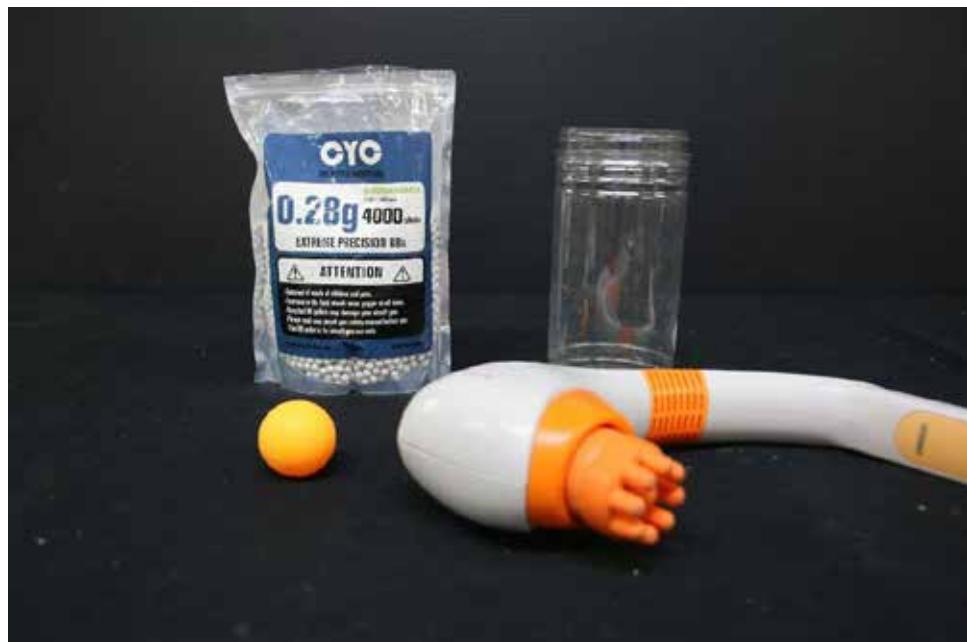
密度の小さなものは密度の大きなものに浮く。木は水に浮かぶが、木を水に浮かべ凍らせてから、上下を逆さまにしても木は浮かんでくることはない。木が水に浮くことを説明するためには、水の分子が運動していることが必要である。昔は米粒を使っていたが、近年では、食べ物を無駄に使うことに抵抗があるので、BB 弾を使用した。ピンポン球が浮かび上がるには、ピンpong球が受ける重力よりも浮力が大きくならなくてはならない。ここでは、ピンpong球上部の BB 弾の運動よりも、ピンpong球下部の BB 弾の運動が激しくなるように振動を与える必要がある。
