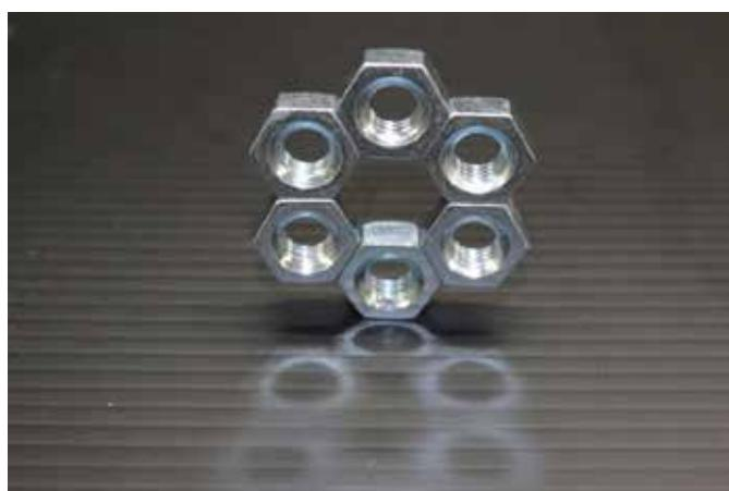
鉄の六角ナットを 6 個接触させ、その中央に電線を通して、12V のバッテリーでショートさせると、電流が作る磁場によってナットが磁化し、鉛直に立てることができる。12V バッテリーは、コンデンサーに蓄えた電流の扱いほど危険ではないので、磁化の実験には使いやすい。
