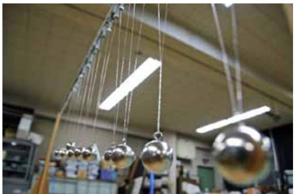
1番短い振り子が60回振動する間に、2番目に短い振り子は59回、3番目に短い振り子が58回振動するように長さを計算し、15個程度の振り子を並べる。振り子の長さを微調整できるように、ネジをうまく使って作るとよい。一斉に振動を始めると、15個の振り子が、興味深い振動を行う。
