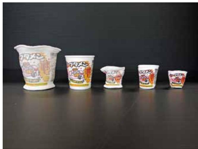
かつては、カップヌードルの容器を深海に沈めると、水圧のために圧縮され小さくなる実験が行われた。カップヌードルの容器は発泡スチロール製から紙に変わりこの実験はできなくなった。しかし、ブタメンの容器は、まだ発泡スチロールを使っているため可能である。写真的右2つは、東京海洋大の協力を得て、578m、1308mまで沈めて頂いたものである。さて、圧力鍋の内部も高圧なので、ここにブタメンの容器を入れるとどうなるか。使用した圧力鍋のゲージ圧は80 kPaなので、およそ1.8気圧になる。空の容器がお湯につからないように針金の台を入れその上にのせる。水を少量入れふたをし、圧力鍋から蒸気が激しく出だしたら火を止め、一気に圧を抜く。ふたを開けると写真の一番左端のような膨らんだ容器となる。左から2番目が普通の状態である。これは、ポン菓子ができるのと同じ原理で、圧縮されていた空気が急激に膨張して、発泡スチロールの粒の間を押し広げるからである。
