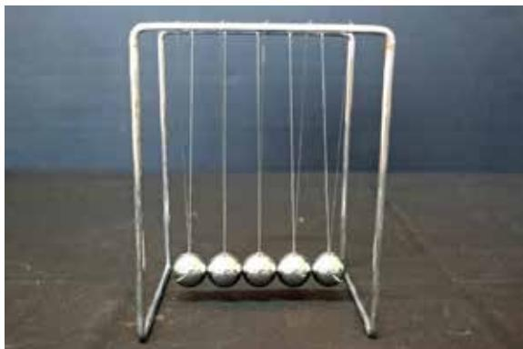
運動量の保存、エネルギー保存を示す教材として、生徒の大好きなおもちゃである。1個を持ち上げてはなす。2個持ち上げてはなす。3個持ち上げてはなす。4個持ち上げてはなす。両側の1個ずつを持ち上げて同時にはなす。両側の2個と1個を同時に持ち上げてはなす。両側の1個を持ち上げて少し時間をずらしてはなす、などたくさんのバリエーションを楽しめる。1個を  $v$  でぶつけるとなぜ2個が  $0.5 v$  ではじき飛ばされないのかと言う問い合わせも面白い。
