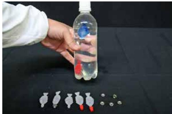
炭酸飲料用のペットボトル（500ml）に浮沈子を入れ、水をいっぱいにしてふたを閉める。生徒にはばれないように指でペットボトルを押すと、浮沈子は沈む。醤油入れの金魚の水の量を少し変えておくと、片方だけを沈ませたり（容器を弱く押す）、両方同時に沈ませたり（容器を強く押す）できる。浮力  $F = \rho V g$  の金魚の体積  $V$  が小さくなることで浮力  $F$  が小さくなり、重力とのつり合いが保てなくなり沈む現象がわかりやすい。M6ナットはステンレス製が鋳びなくてよい。
