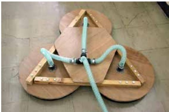
人が乗れるホバークラフトは、1台は作っておきたい。黒板消しクリーナーか送風機、洗濯機のドレーンホース、バイクのタイヤチューブなど身近な材料で廊下を摩擦力をほとんど受けずに滑るホバークラフトを作ることができる。
