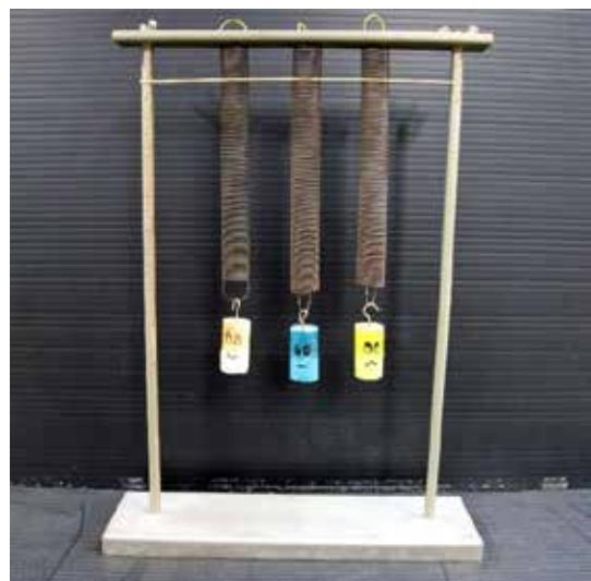
振り子3兄弟は、周期が同じ（バネ定数と物体の質量が同じ）振り子の上部を輪ゴムでつないだ共振の実験装置である。見方を変えるとエネルギーのやりとりの教材としても利用が可能である。周期の微調整は、バネを引っかける位置を調節（バネを回転）することで可能になっている。
