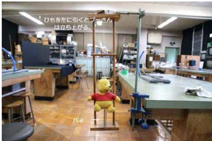
エネルギーと仕事の関係を示す実験装置として、「プーさんのブランコ」がある。ブランコを次第に大きく揺らすための動きを簡単に示すことができる。木枠で作ったブランコが、スタンドの上部のベアリングの付いた棒で支えられていて、図の前後方向に振り子運動が可能な構造になっている。プーさんのぬいぐるみは頭からおしりを貫通させる穴が空いていて、頭にひもがつながれ、上部から左に曲がり、左向きに引くと、プーさんは上昇する。プーさんのおしりとブランコの下部は
