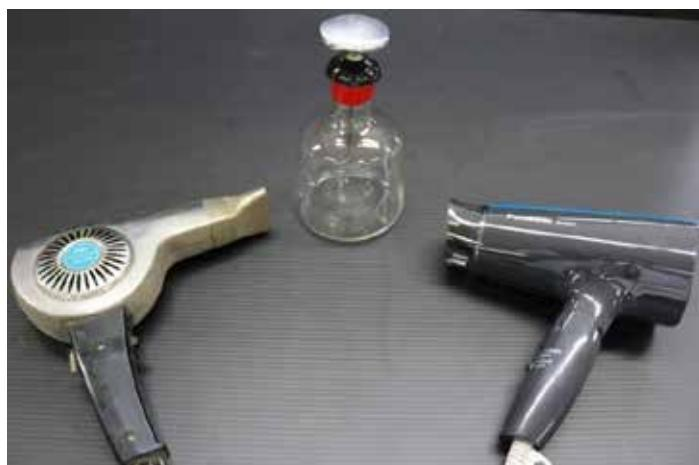
マイナスイオンドライヤーは、箔検電器をマイナスに帯電させると利用できる。写真左側は、昭和の時代のドライヤーでマイナスイオンは発生しない。
