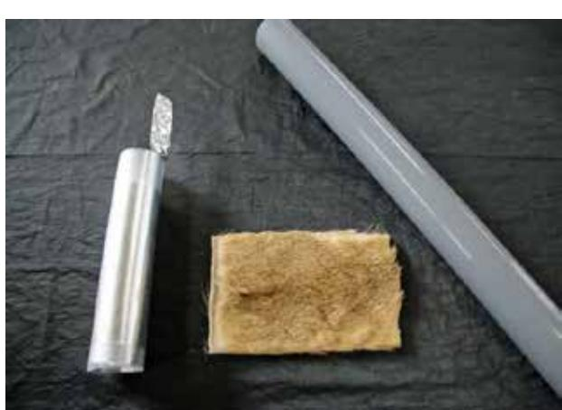
クリアファイルの中にアルミホイルをはみ出さないように挟む。クリアファイルの外側に同じ大きさのアルミホイルを貼り付ける。これで、クリアファイルが誘電体、アルミホイルが極板のコンデンサーが完成する。外に貼り付けたアルミホイルが外側になるように巻く。挟んだアルミに電子を送るために細長いアルミホイル（アンテナ）を挟んで出しておく。塩ビパイプを毛皮でこすってアンテナに電子を送る。生徒に手をつながせて輪を作る。片方の端の生徒が筒の外を持ち、もう片方の端の生徒がアンテナを触った瞬間にたまたま電荷が放電され 100 人脅しが体験できる。
