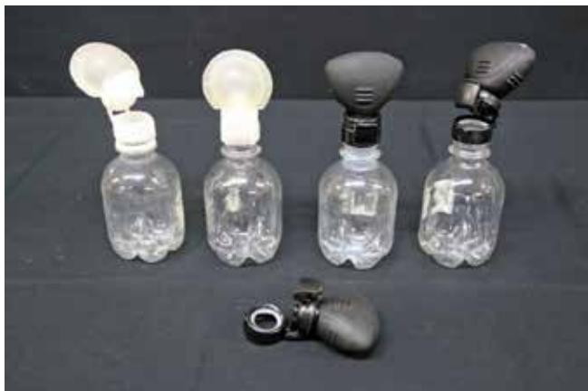
断熱膨張を示すには、炭酸飲料の保存用のキャップが便利である。容器は小さな炭酸飲料用のペットボトルがよい（かつてはチビレモンという炭酸飲料の容器があった）。容器に数滴のエチルアルコールを入れておくと演示効果が高い。ふたをして10回ほどポンピングをして中の空気圧を高める（容器が大きいとこの回数が増える）。ふたのロックを外して急激に空気を膨張させると、断熱膨張により気体の温度が下がり、内部に含まれていたエチルアルコールが凝結し、雲が生じる。
