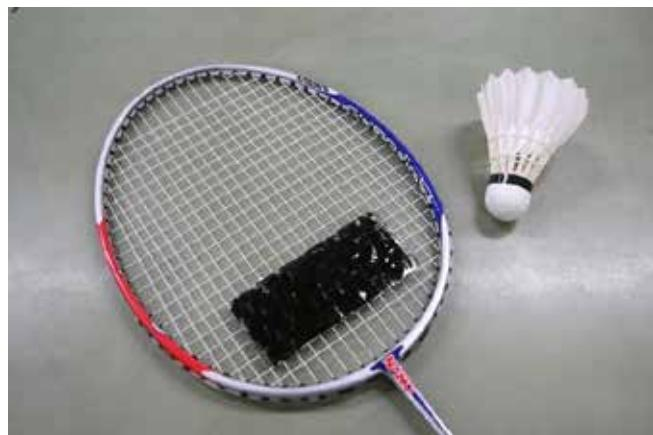
バドミントンラケットに幅の広いスコッチテープを貼ると、シャトルが当たったときに小鼓をたたいたときのようなおもしろい音が鳴る。普通にガットにコルク部分が当たるだけでは、カンという甲高い音がするだけだが、面積の広い振動板が多くの空気に振動を伝えるので、大きな音が鳴る。写真はわかりやすくするために、スコッチテープに着色を施した。
