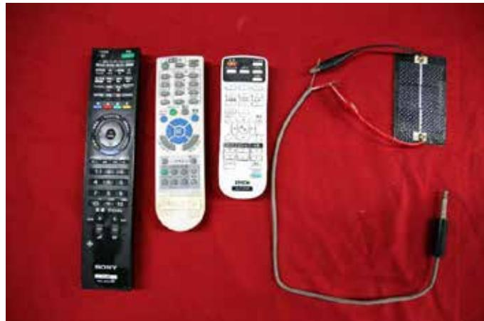
赤外線はスマートホンやデジタルカメラのCCDがとらえる。太陽電池で受光した信号をオシロスコープでその波形を見ることができる。しかし最もおもしろいのは太陽電池をアンプ付きスピーカーにつないで音としてとらえる方法だ。チャンネルによる音の違いはとらえられないが、メーカーによって音程やリズムが変わることもある。
