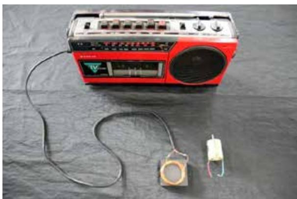
スピーカーの構造は、ホルマル線をまいてコイルを作り、フェライト磁石(40mm×40mm×9mm)の上に置き、ラジカセなどの外部スピーカー端子にコイルをつなぐことで、その振動を味わせたい。イヤホンジャックしか無い場合は、音量が小さいのでアンプを挟む方がよい。小さなモーターも外部スピーカー端子につなぐと音楽が聞こえておもしろい。
