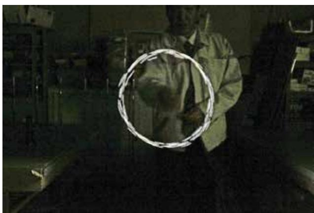
100V 用の LED を交流電源に接続すると点滅する。LED をじっとしておくとわかりづらいが、移動させたり回転させたりすると、点滅の様子がはっきりわかる。関西では 60Hz なので、1 秒間に 60 回点滅する（逆方向の電流では点灯しない）。教室を暗くして 1 秒間に 4 回転させるペースで等速円運動を行うと、円周に 15 個の明かりが見える。
