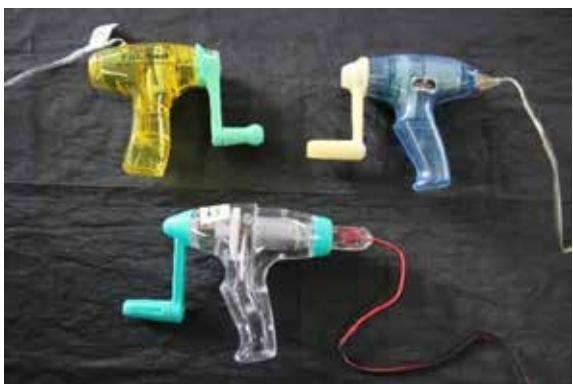
手回し発電機はモーターを発電機として利用している。様々な実験が可能である。
