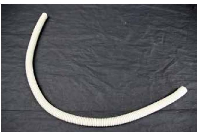
エアコンの室外機に使われるドレーンホースは、その一方の先端を持って図上で振り回すと音が鳴る。中心から外に向かう向きに風がながれ、ホースのでこぼこによって渦ができる。口をつけて吹いても鳴るが、ホースの長さを変えても音程は変わらない。ホースに刻まれたでこぼこが定常波を決める要因になっているものと考えられる。
