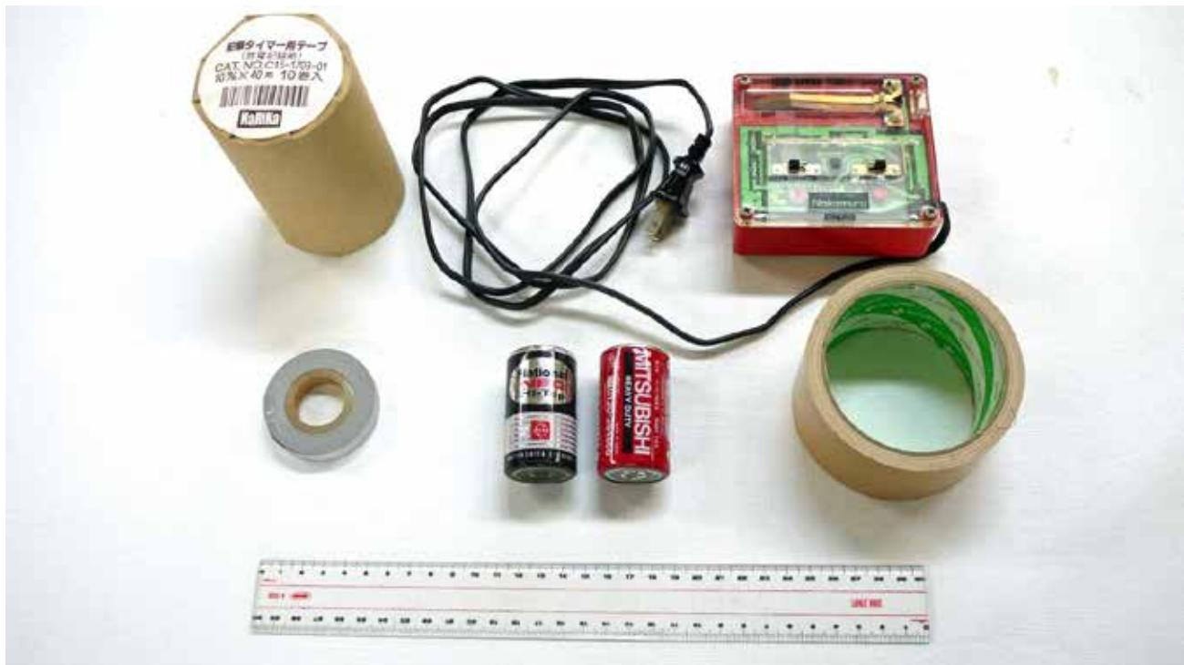
おもりは使用済みの単1電池（D battery）、記録テープは一人50cm（一人50cmで十分である）、ガムテープで単1電池に取り付けた。記録タイマーの接触不良は、ねじを4カ所外し、ふたを取り電極の反り返りを調整するとすぐに直る。
