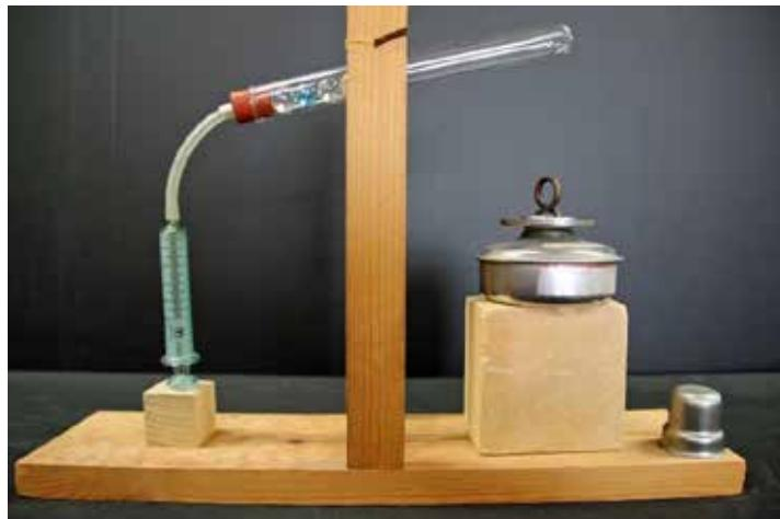
試験管と注射器をシリコンチューブでつなぎ、ビー玉を入れると簡単なスターリングエンジンができる。スターリングエンジンはガソリンエンジンやディーゼルエンジンのような内燃機関ではなく、外部から熱を与える外燃機関である。試験管の空気を暖めると膨張し、注射器のピストンが出て試験管の傾きを変える。ビー玉が移動し、空気を冷やすため注射器のピストンが容積を縮ませる方向に移動する。
