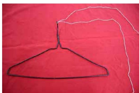
ハンガーを糸で結ぶ。両耳の図の斜線部分を耳の穴に押しつけその上に糸を当てて指で押す。糸が耳以外に当たらないようにハンガーをつり下げて、揺らして机に当てる。ゴーンというお寺の鐘の音のような莊厳な響きが聞こえる。スプーンを吊しても聞こえる。糸が高い音を伝えにくいために、低い音が聞こえるらしい。
