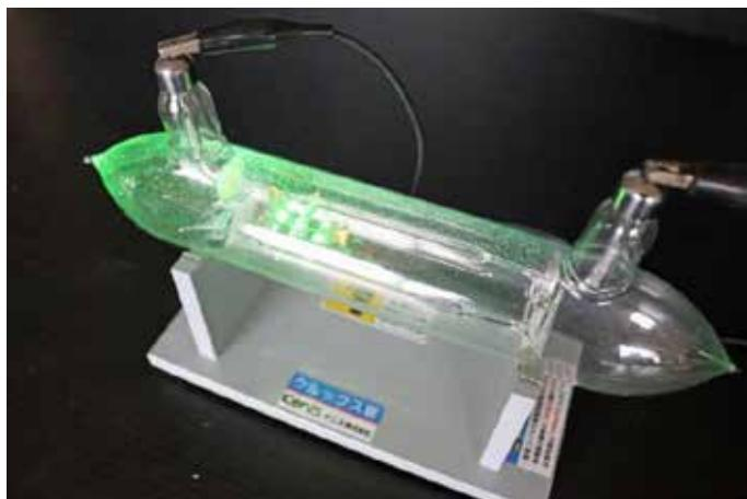
クルックス管も多くの学校に眠っている。誘導コイルがあれば、放電を見せることができる。磁場によって曲がる様子、羽根車に当てるとき熱エネルギーが発生し、当たった側が押される様子などを見せることができる。
