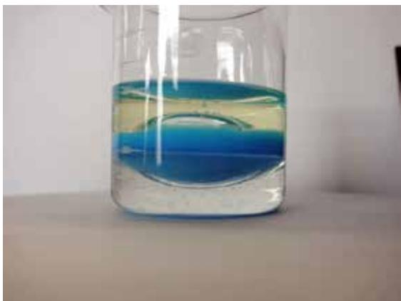
回転台の中心に容器を置き、容器を回転させると、内部の液体は遠心力を受け、外側がもりあがる。
