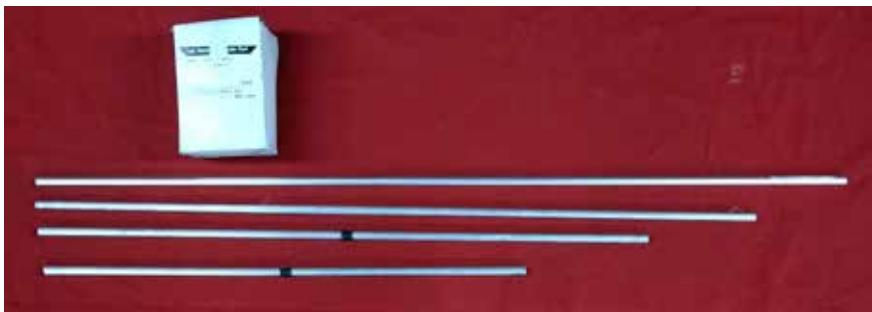
気柱の共鳴現象のモデルとして、アルミ棒の定常波実験は興味深い。気柱共鳴においては両開口端の気柱とアルミ棒に生じる定常波が一致する。ロジンを指につけこすって音を出すが、音を出すことをマスターすると、2倍振動や3倍振動まで作り出す生徒が多い。
