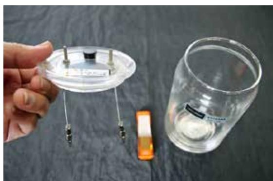
ピンの中でシャーペンの芯に電流を流すと、ジュール熱が発生し芯は光る。ピンの中には酸素があるため芯は1分もたたないうちに燃えて断線する。ドライアイスを入れておいてピンの中をCO<sub>2</sub>で満たすか、使い捨てカイロの中身を袋から出してしばらくおき、酸素を取り除くかしてから芯に電流を流すと10分以上光らせることも可能である。
