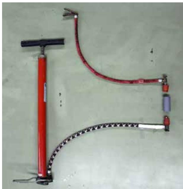
**準備** 自転車用空気入れ、ゴム栓（3号）、金属パイプ（外径8mm）、水道管またはアクリルパイプ
