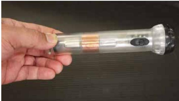
電池がいらないシャカシャカライトは、内部の磁石とコイル、電気を蓄えるコンデンサーが透けて見えるようになっている。磁石がコイルを通り抜けるとき、電磁誘導によりコイルに逆起電力が発生し、回路に電流が流れる。これにより LED 電球が点灯する。スイッチを off にして磁石がコイルを往復するように振ると、コンデンサーに電気量が蓄えられる。電磁誘導やコンデンサーの働きを理解するのに役立つ教材である。
