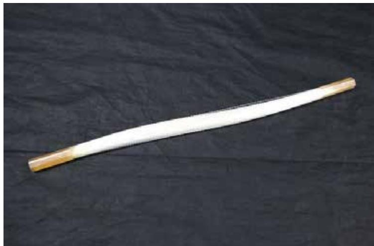
$\phi 0.5\text{mm}$ 、長さ 30cm の光ファイバーケーブルを 331 本結束した構造で、光ファイバーどうしが交差しないように作られている。結束線の一端を本の活字やイラスト、写真に密着させ、反対側から見ると、テレビの画面を見るかのように、活字や絵が浮かぶ。中央部を曲げてもきれいに写る。各ファイバーに入った情報が、全反射を繰り返し、反対側までその情報が送られることで、観察が可能である。
