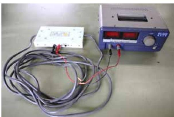
パスカル電線は、+極から-極に1本の電線がつながっているように見えるが、1本の電線の中に被覆電線が10本入っていて、それが+極から-極に至るまで10周するように接続された電線である。たとえばこの電線に、15Vの電位差を与え、4Aの電流が流れたとすると、実際にこの電線の周りには40Aの電流が流れた場合と同じ磁場が生じる。京都パスカルによって開発されたためこの名称で呼ばれる。
