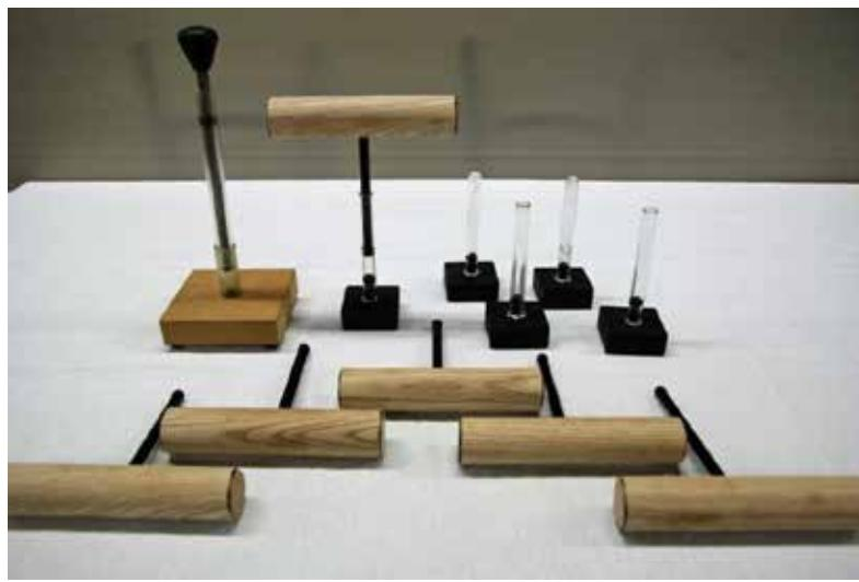
断熱圧縮により、紙を発火させる実験装置は、各教材会社から販売されている。破損が多く、ガラス製のシリンダーのものは割れて手を怪我することも多かった。写真の装置は、シリンダーに熱伝導率の低いポリカーボネート製パイプを使用することで、シリンダー容積を小型化することに成功した大阪大谷女子高校の豊田将章先生が開発された圧気発火器である。ピストンの行程はわずか 5cm で、ティッシュペーパーやトイレットペーパーが発火する優れものである。台にはゴムを使用し、シリンダーの破損が、ゴムの弾性とシリンダー
