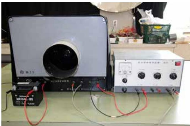
$e/m$  の測定は、1897年に J.J. トムソンによって行われた。電子の質量の測定は容易ではないが、 $e/m$  の値は高校の実験室でも行えるので、多くの学校にこの装置は眠っている。電子銃で電子を加速させるための電圧を  $V$ 、磁場の磁束密度を  $B$ 、電子がローレンツ力を受け等速円運動する際の半径を  $r$  とすると、 $e/m$  の値は次の式で表される。
