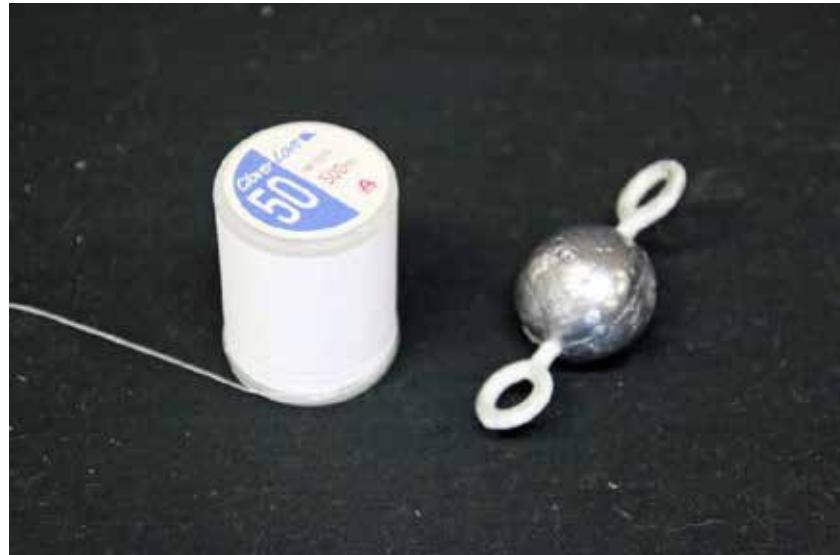
釣り用の鉛のおもり(120gを使用したが、もっと大きても可)、の上下にドリルで穴を空け、適當な大きさのヒートンを取り付ける。木綿製の糸(50番を使用したが、他のものでも可)を上下に結び、上の糸をスタンドにくくりつける。下の糸を引き糸を切る。このとき下の糸の引き方によって、上の糸が切れるか、下の糸が切れるかが決まる。
