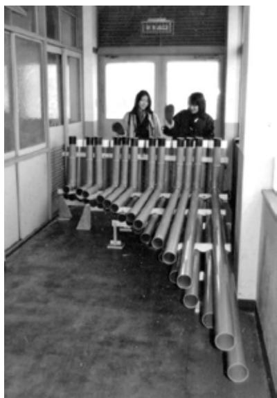
ベトナムにクロンプットという楽器がある。これによく似たパイプホンを最初に考案したのは札幌在住の音楽家、河辺幸吉さんである。物理の教材として優れていると思い、使わせて欲しいとお願いしたところ、快くかまわないという返事を頂いた。塩ビ製水道管（VU75）を切って組み立て、ビーチサンダルでたたくと管内の気柱に定常波ができ心地よい音が鳴り響く。実験室の前に常設してあり、生徒は自由に演奏している。
