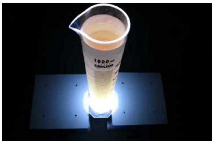
メスシリンドラーに水を入れ、フローリング用のワックスを溶かす（実験 93 より多めがよい）。下から白色の LED ライトで照らす。メスシリンドラーの下部は日中の青空と同じく水色がかった見える。上部から除くと夕焼けと同じオレンジ色に見える。光の散乱の教材として優れている。
