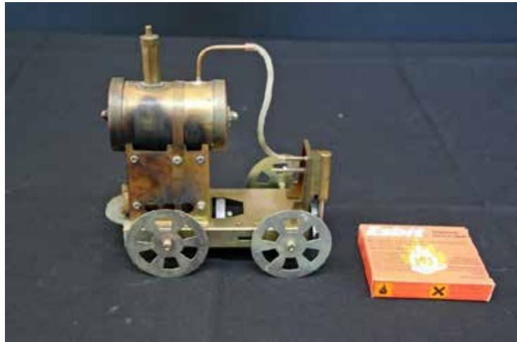
熱エネルギーで水を沸騰させると、体積は 1600 倍になる。水蒸気の勢いを回転運動に変える首振りエンジンは、構造が単純で熱エネルギーを力学的エネルギーに変換させる装置として興味深い。写真は「ベビーエレファント号」で、組み立てキットが現在でも販売されている。
