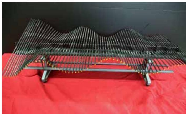
よく使われるウェーブマシーンは左図のタイプで横波をゆっくりと見せることができる。このマシーンの最大の魅力は、波が伝わる速度がゆっくりであることだ。それでも、動画で撮影してさらにゆっくり進ませるとよりわかりやすい。波源が1回振動する間に1波長波が進むことは、スローモーションで撮影して見せておきたい。自由端反射と固定端反射、自由端で定常波が腹となること、固定端で定常波が節となることはこの装置が一番わかりやすい。
