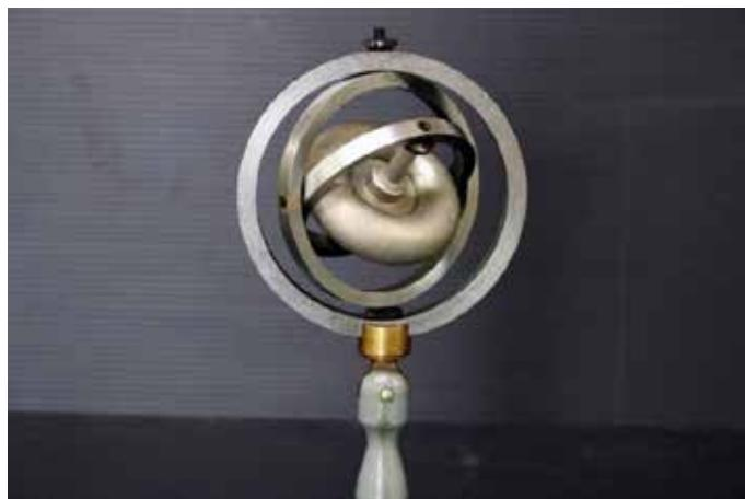
角運動量保存則に従って、回転する軸の方向を維持する様子を示す装置である。上の写真は、学校に眠っていたもの。かつては慣性モーメントや角運動量保存を教えていた時代があった。下は、CD板とモーター、電池で製作したもの。
