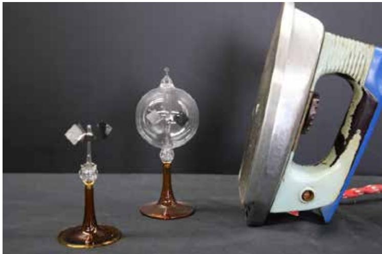
ラジオメーターは薄い空気を入れたガラス容器内の4枚羽根のすすを塗った黒い面が熱を吸収し、気体分子の運動が激しくなることでそれに押され回転する様に作られている。窓際におき光を当てると回転するが、ろうそくやアイロンの熱でもよく回転する。ガラスから4枚羽根を出して実験すると、空気が濃すぎるため回転しない。
