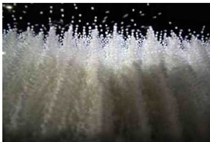
音波の定常波を見せる実験として、クントの実験は欠かせない。市販のものは音量が小さいので、オーディオアンプ、スピーカーを用いて低周波発信器の音を大きくするのがよい。できれば、直径 15cm ほどのアクリルパイプを使うと迫力が増す。発泡スチロール球は見事に踊り出す。この実験では変位の腹で発泡スチロールが激しく動くが、使用する粒子の大きさが小さくなると変位の節で激しく振動することも知られている。
