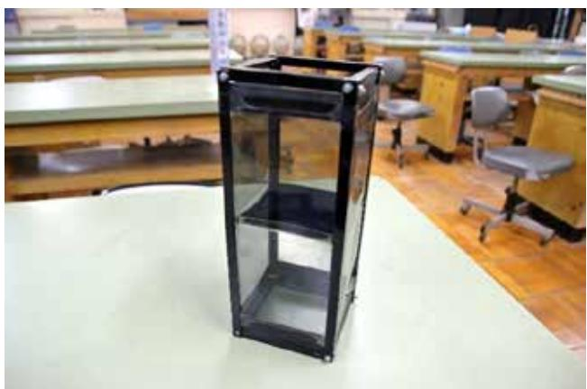
箱の側面に、上部と下部で偏光板を $90^\circ$  ずらして貼ると、中央に黒い壁が現れる。実際には壁はないが、上部の偏光板と下部の偏光板が重なるため暗く見える。
