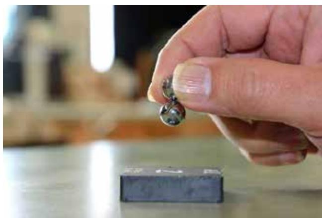
フェライト磁石（40mm×40mm×9mm）のそばで鉄球2個を接触させると、鉄球は磁力によってひっつく。磁場の中で鉄が磁化されているためである。フェライト磁石からの鉄球を遠ざけると、鉄球の重力が磁力に勝って落下する。
