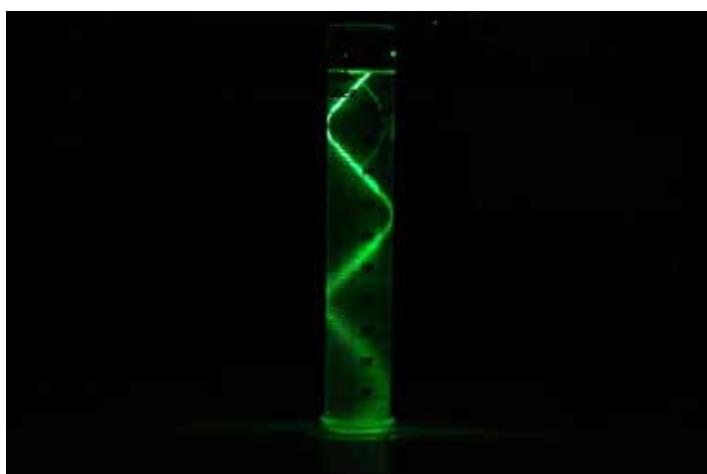
メスシリンドラーに水を入れ、フローリング用のワックスをごく少量溶かす。上部から斜めにレーザー光線を照射すると、全反射を繰り返し、底まで達する様子が観察できる。
