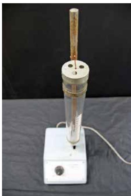
左図の装置は、ガラス製のシリンダー内に、鉄球を入れ、下部にあるピストンを振動させることで鉄球を運動させることができる。鉄球の持つ運動エネルギーの平均値が温度を表している。上部にも軽いピストンのふたがあり、おもりをのせることができる。温度を一定にし、おもりを変化させ体積の変化を調べることでボイルの法則が理解できる。また、おもりを一定（圧力一定）にし、温度変化と体積変化の関係を調べることでシャルルの法則が理解できる。
