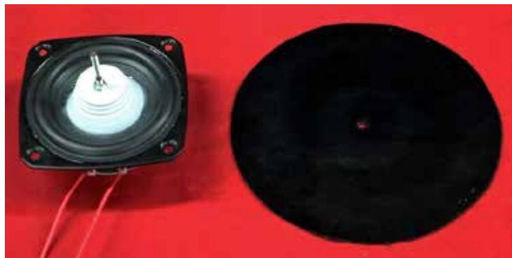
スピーカーのコーン紙にプラスチックの薄いカップの底を木工ボンドで止める。カップの内側からボルトを固定しておき、このボルトに下敷きなどを両側からナットで止める。このスピーカーに低周波発信器から音を送ると、クラドニー図形を見る事のできる装置となる。食塩をまくと、ある振動数ごとに、同心円の定常波の波形が現れる。残念ながら、音波の波長より短い倍音の定常波のようだ。
