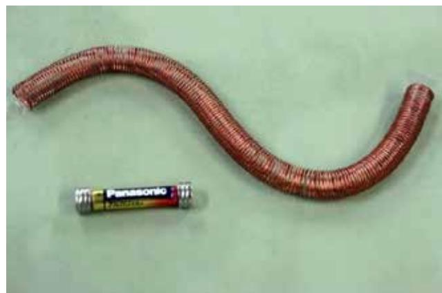
一時ブームになった実験であるが、説明は意外と難しい。コイルは被覆されていない銅線を巻いて作り、単3電池の両側にネオジム磁石を両外側がN極になるか、両外側がS極になる様につける。両外側がN極の場合はコイルのS極側に引かれ、N極側から反発力を受けて進む。地球の北極、南極を貫くトンネルの南極側から両外側がN極になるにした棒を落とすと北極から飛び出すということなるだろうか。
