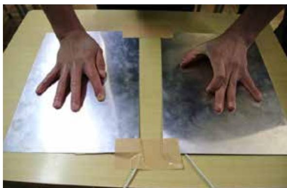
感電体験には賛否両論があるが、安全対策と本人の同意があれば、電気を安全に扱うための体験として是非経験させたいと考える。2枚のアルミ板に電線をつなぎスライダックの出力側につなぐ。アルミ板は、教卓や木の机にショートしないようにガムテープで留める。絶縁状態の生徒に、両手をアルミ板の上に置かせる。スライダックで0Vから徐々に電圧を上げ、ダメですという声で電源を落とす。多くの生徒は電流により筋肉が縮み指が曲がる経験をし、100Vの電位差を想像できる。3人4人が手をつなぎ直列接続の状態で同じ実験をすると、100Vまで耐えることができ、直列つなぎの理解もできる。
