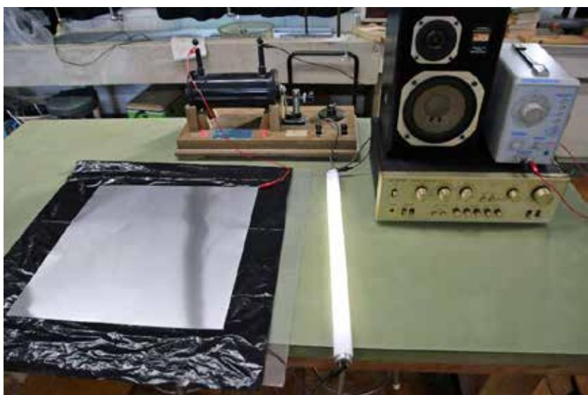
低周波発信器にアンプをつなぎ、スピーカー端子から音声電流を取り出すと、周波数を自由に変えることができる交流電源になる。これを利用すると、RLC回路の共振周波数を示すことができる。
