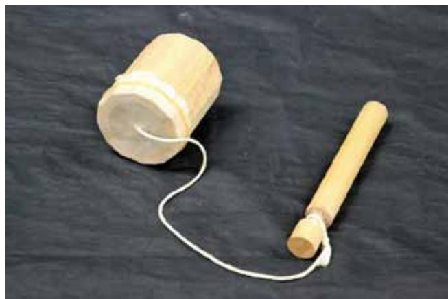
たこ糸が棒をこするところに、松ヤニを塗っておくと摩擦により糸が振動する。これだけでは音が小さいが、糸の先に振動板をつけると、振動板が振動し、空気に触れる面積が大きいため、大きな音を空気に伝える。蛙の鳴き声や蝉の鳴き声に似た音が響く。音が振動であること、振動板が音を大きくすることがわかる。
