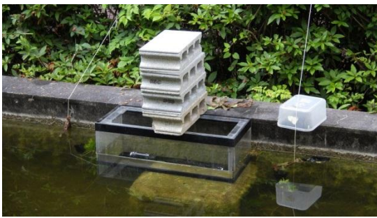
設置したビデオカメラ（防水ではないので水槽内に設置）
