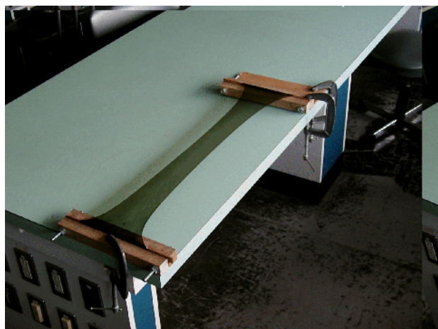
図 1 偏光板を引き延ばしているところ
