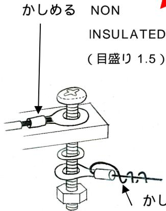
かしめずに、ステンレス線を巻き付ける。
