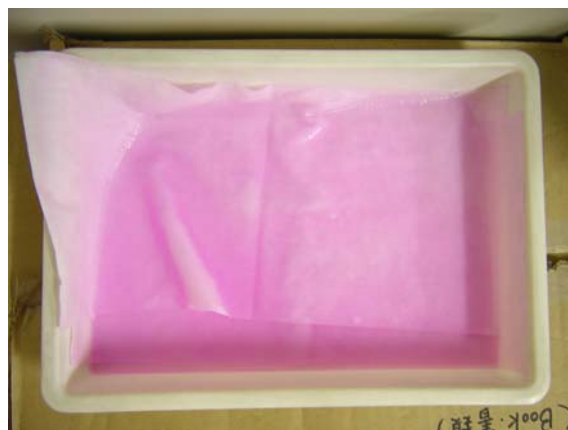
図7 亜硝酸態窒素などの廃液の蒸発乾固
