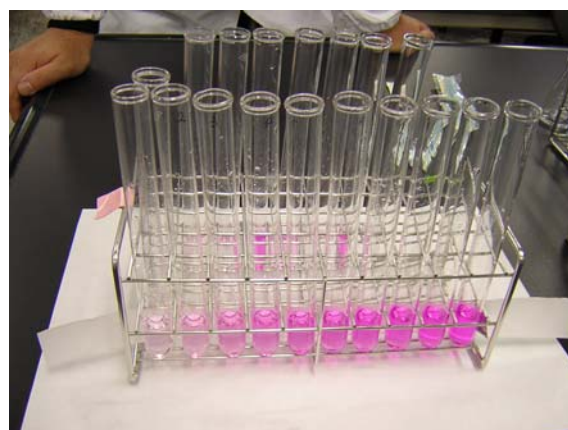
図6 10段階に作成した亜硝酸態窒素の標準色列
