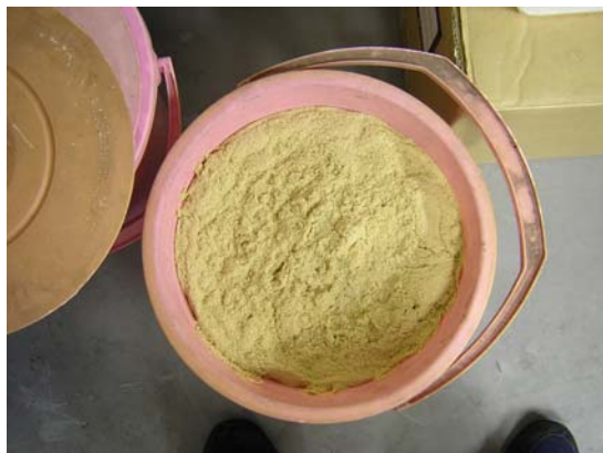
図6 コンポストによる含フェノール廃液の処理
