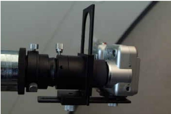
図2 コンパクトデジタルカメラの取り付け
