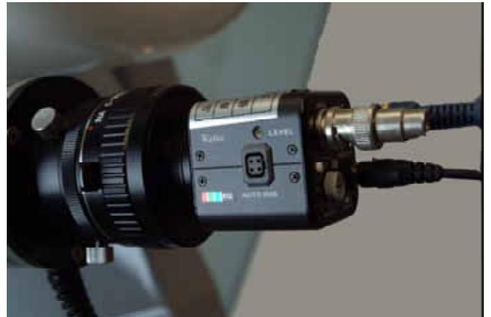
図3 CCDビデオカメラの取り付け
