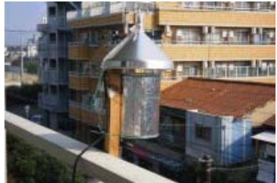
図21 計測用の簡易百葉箱
