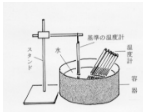
図 8 温度計の検定の仕方
