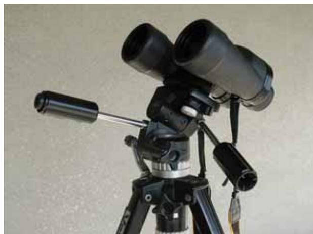
図4 双眼鏡をカメラ三脚に取り付けた様子
