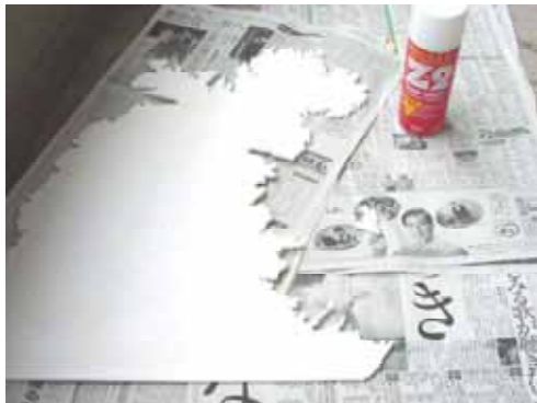
図9 発泡スチロール板の裏面に接着剤塗布
