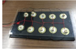
図6 圧電素子10個を並列につないだもの 実験結果
