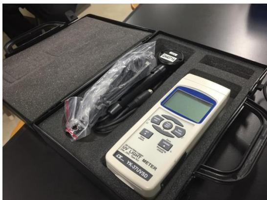
写真10 実験3に使用した紫外線検知器
