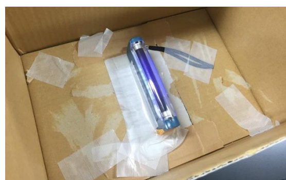
写真7 装置に装着された UV ライト ・写真6 の溝の部分にライトがはまるように作った
