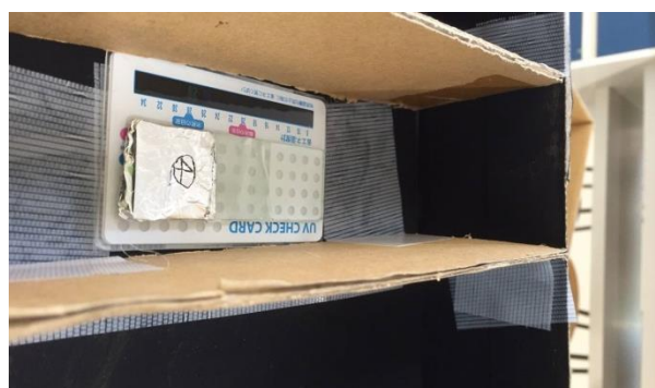
写真6 実験装置内に設置したプレパラート ・ライトの着いた箱を上から土台に覆いかぶせるようにしてセットした
