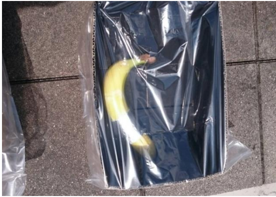
写真1 バナナを用いた長時間での日焼け防止製品の検証実験で自作した装置
