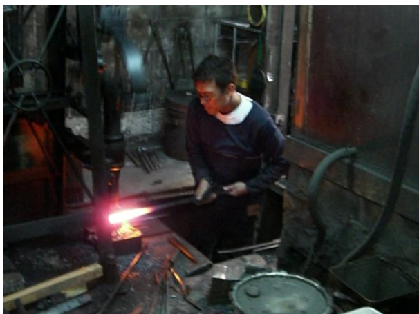
1600 度にもなった鉄をたたいて延ばし、刃物の形にするまでの作業を見学させて頂きました
