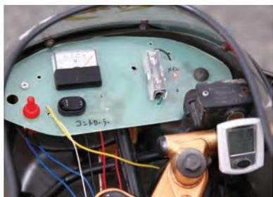
メーターパネルは完全オリジナル。プレート上に電圧計、コントローラスイッチ、インジケータランプ、ヒューズが配置されている。
