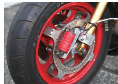
バッテリーエネルギーは全て走行に供給するため、フロントホイールにオリジナルの小型車輛用無負荷発電機を搭載。保安部品の作用用電力を発電させている。
