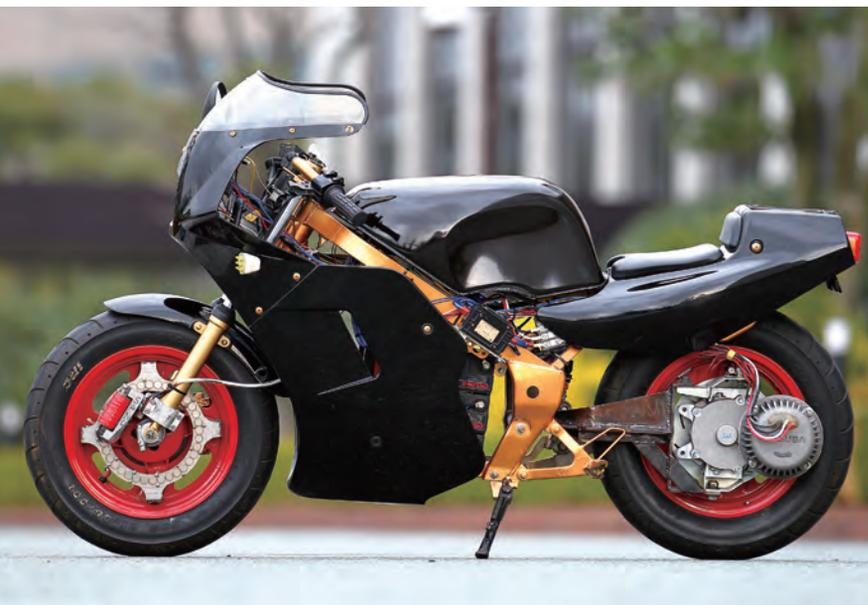
ベースとなったYSR50は、2007年に「うるし塗装バイク」として大阪モーターサイクルショーに出展。各方面に反響を受けたため、今回のプロジェクトにおいても「うるし塗装を傷つけないこと」が、作業目的に掲げられていた。EV化における主要な改造点は、リアホイールへの小型EVモーター搭載と、片持ちスイングアームの作成。バッテリーは航空機用のドライセルバッテリーを使用している。改造により車輛バランスも変わっているが、教習所で行った走行テストでは、一本橋で11秒以上のタイムを出すなど、低速時の走行安定性も高いレベルで実現している。
