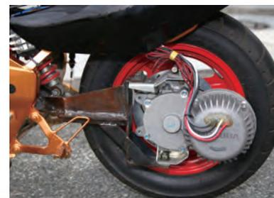
モーターはショーダクリイティブの協力のもと、ミツバの小型EVモーターを購入し、リアホイールに結合。リアには回生ブレーキが採用されている。
