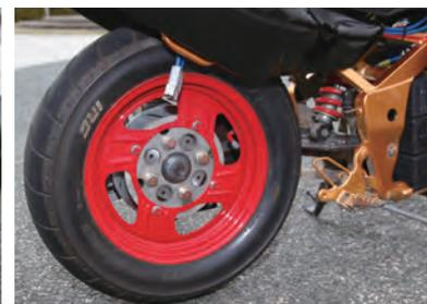
溶接時の溶接ひずみの発生を抑え、製作時間の短縮、軽量化を図るために片持ちスイングアームを採用。そのためリアの右サイドはスッキリしている。
