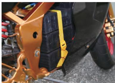
航空機用のドライセルシールド純鉛バッテリー12Vを4直列・48Vを搭載。リチウイオンバッテリーより安価で、簡素な充電回路でも性能を発揮するという。
