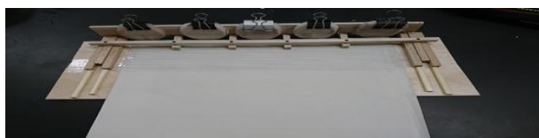
図 1 消しやすさを測定するため使用した装置
