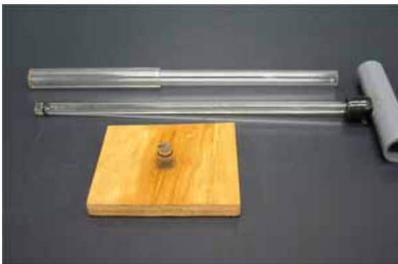
図1 製作した圧気発火器 上からそれぞれ、パイプ、ピストン、台
