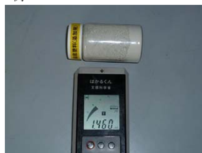
はかるくんを使った船舶塗料の放射線量の測定例
