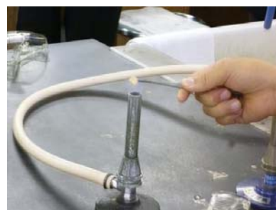
銅板を亜鉛メッキしたものを炙る様子
