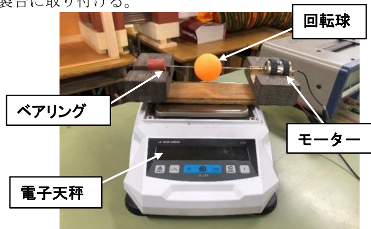
（写真1）「回転球装置」と重さ測定の様子
