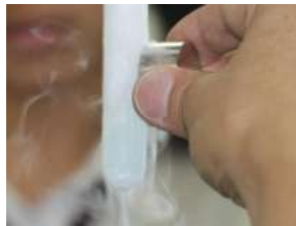
写真⑫ 液体酸素も磁石に引き寄せられる
