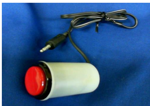
図6 フィルムケースを改良したスイッチ
