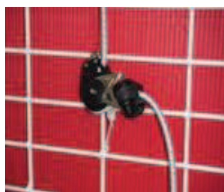
図 6 カムクリート付きブロック(左)ヘッドサポート全容(右)
