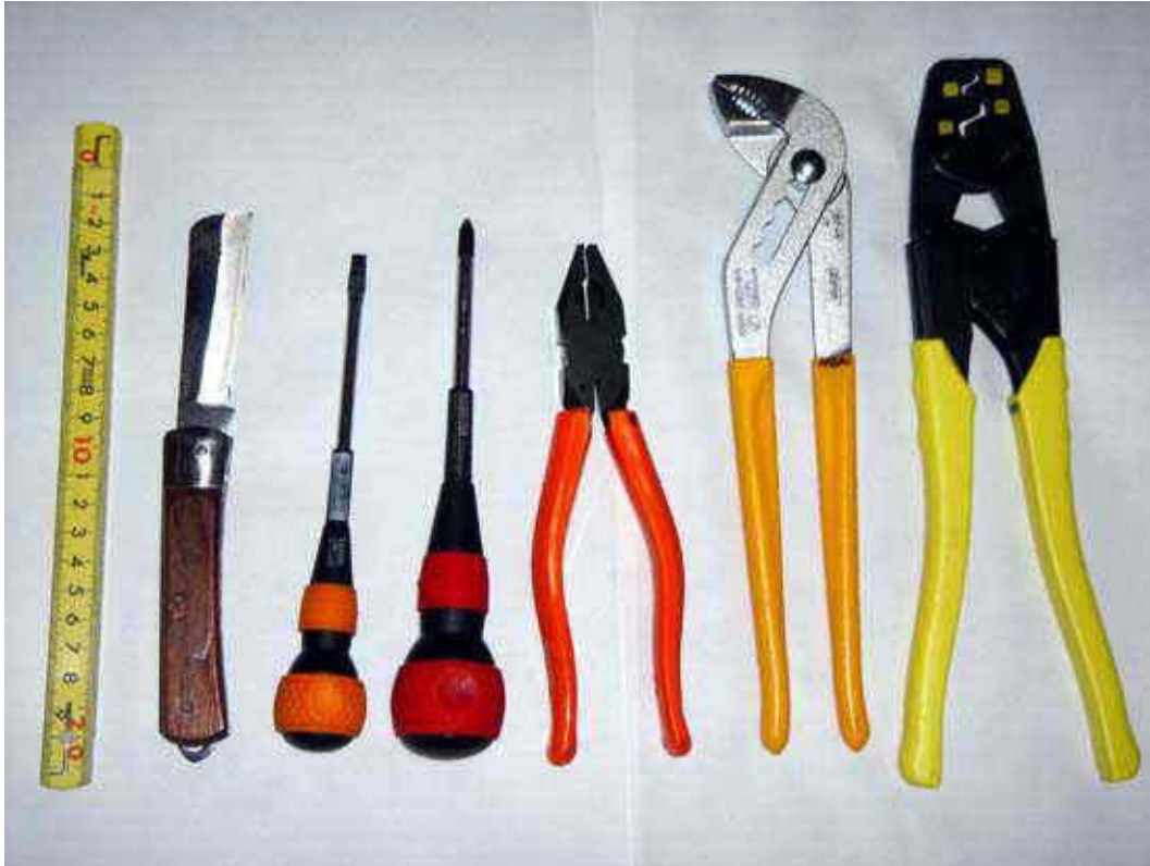
折尺 電工用ナイフ 電工用+ドライバー 電工用ペンチ ウォーターポンププライヤ リングスリーブ用圧着ペンチ
