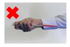
ピペットを横に向けすぎると液体がゴムキャップの方に流れてきます。横に向けすぎないよう注意してください。
