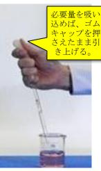
水溶液を吸い込む際には、水溶液にピペットを入れる前にゴムキャップを押さえて空気を追い出しておきます。
