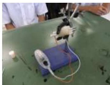
点火装置 ゴム栓にペットボトルをはめる。ゴム栓に突き刺した2本の釘の間で放電が起こり点火される。
