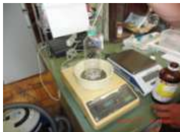
エタノールの質量を測定して、ペットボトルに入れる
