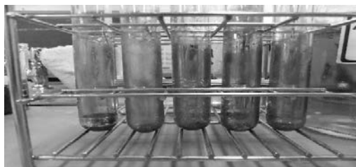
図1 試験管に析出した銅(銅鏡)
