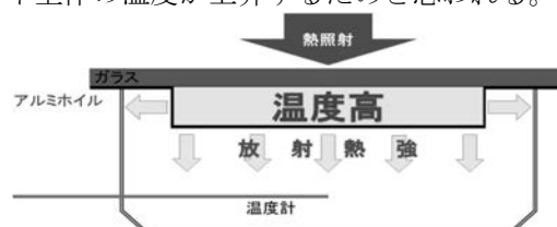
図2 内側隙間と温度上昇
