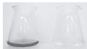
図2 硫酸滴下による色の変化 (左:滴下前 右:滴下後)
