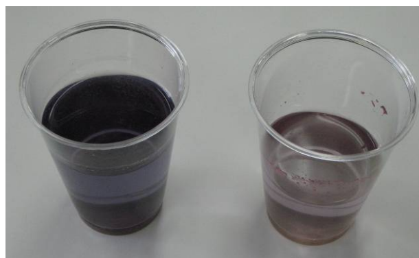
図5 紫イモ粉による水道水と雨水の酸性・アルカリ性判定
