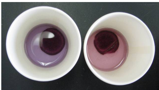
図4 輪切りにした紫イモによる水道水と雨水の酸性・アルカリ性判定
