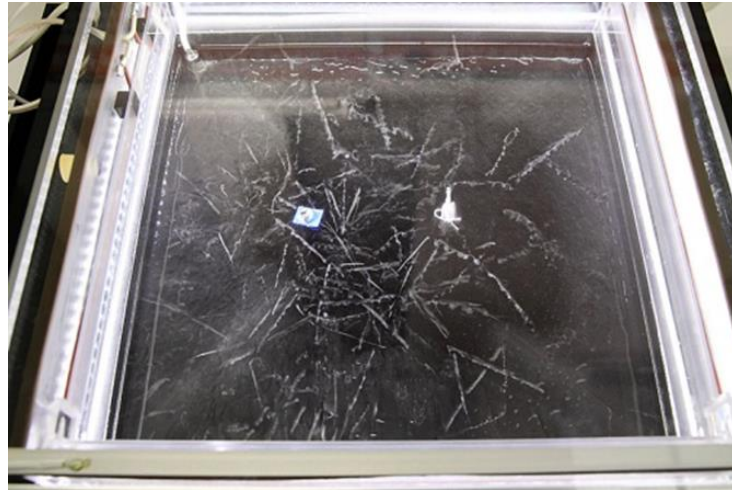
霧箱の写真。中央で白く見える細い線が放射線の軌道。
