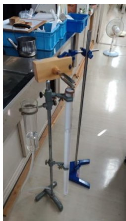
気柱の共鳴を利用した実験の例
