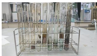
(1)実験後の銅鏡の写真 左から順に加熱時間が短い。
