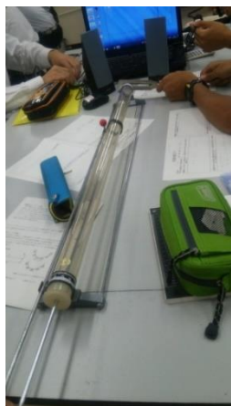
気柱の共鳴を利用した実験の例
