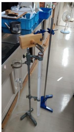
気柱の共鳴を利用した実験の例
