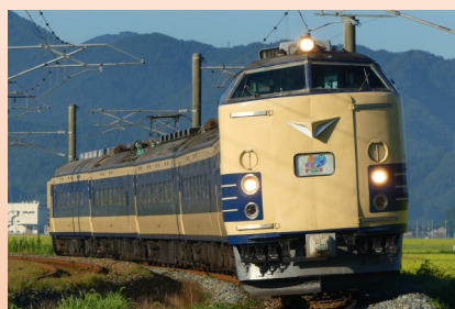
直流1500V、交流20000V(50Hz・60Hz)の三電源で走行可能な電車特急583系
